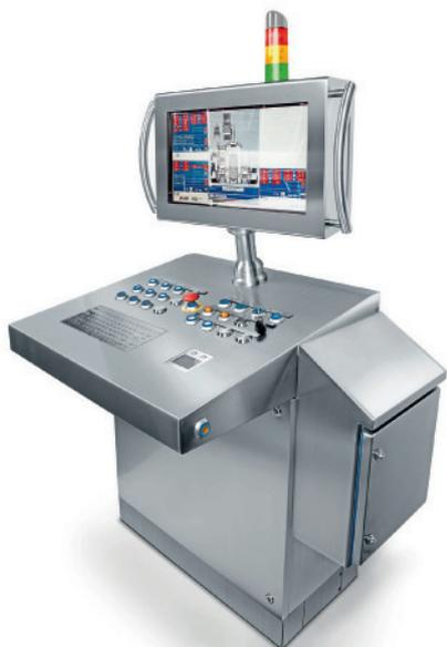
Das Zentrale Bedienpult gewährleistet das effektive Zusammenspiel vollautomatisierter Produktionslinien. Seydelmann
